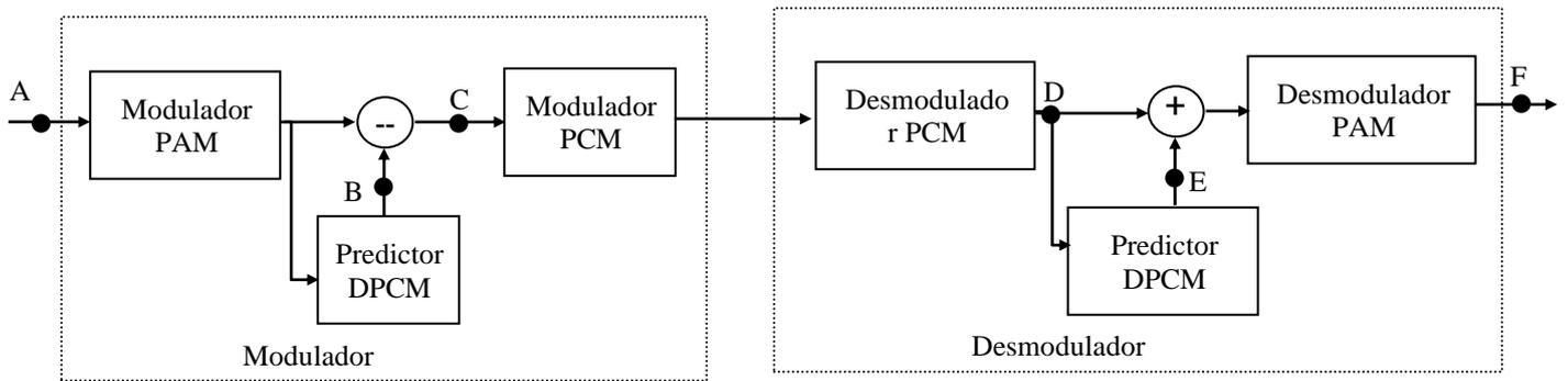
2. Ligue o canal 1 do osciloscópio ao sinal de entrada do modulador PAM. Visualize os seguintes sinais no canal 2 e desenhe as ondas nos diagramas respectivos, escrevendo uma pequena descrição do que desenhou.
