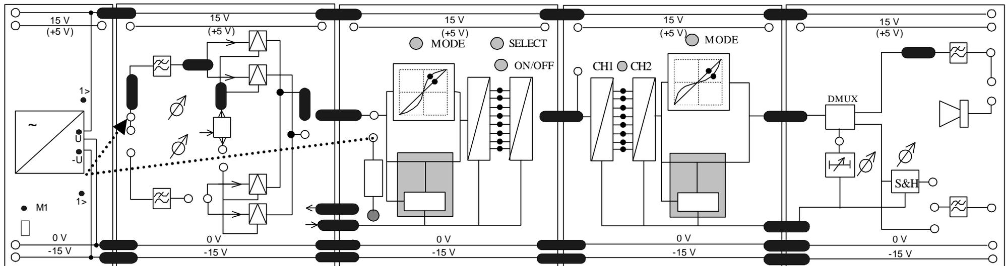
2. Vai-se primeiro experimentar com um valor de tensão constante. Um sinal DC. Para isso ligue a fonte DC do modulador PCM à entrada do filtro passa-baixo do canal 1 do modulador PAM (Como está mostrado na linha a tracejado na figura). Visualize no osciloscópio o sinal de saída do modulador PCM. Como é um sinal DC, vai sempre ficar no mesmo intervalo de quantização, e portanto o sinal é sempre o mesmo no osciloscópio.
