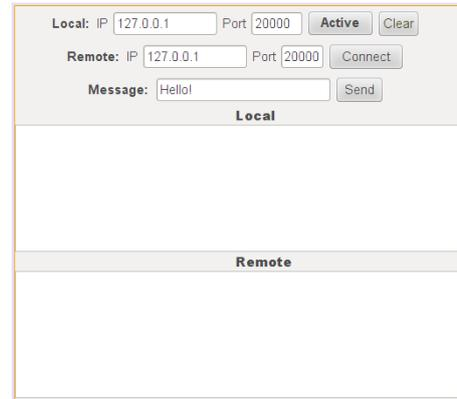
Embora a interface gráfica seja quase igual, a realização é substancialmente diferente porque a comunicação com *sockets* TCP usa duas classes. A classe `ServerSocket` é usada para receber ligações, e cada ligação recebida usa `Socket` para comunicar (e no caso do cliente para iniciar uma ligação). Ver o documento “Introdução ao desenvolvimento de aplicações...” que contém uma apresentação destas classes e exemplos do seu uso.
