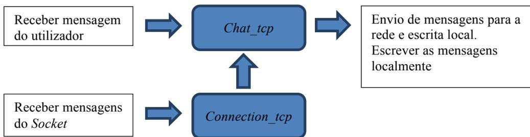
Neste momento já deve ser óbvia a estrutura do programa: Existe uma *thread* sempre à espera de novas ligações. Sempre que existe uma nova ligação é criada uma nova *thread* para ler o *socket* dessa ligação. Quando acabar a ligação essa *thread* é destruída.
