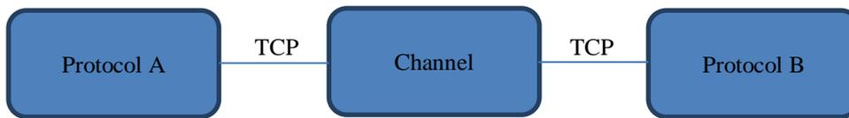
Após arrancar, o *canal* aceita duas ligações TCP de dois programas *Protocol*, começando a partir daí a simulação. O canal realiza um sequenciador de eventos discretos, recebendo os comandos gerados pelos protocolos e gerando os eventos relacionados com o nível físico e com os temporizadores apresentados anteriormente ordenados de acordo com o tempo de simulação. O tempo de simulação é medido em unidades de tempo virtuais, designadas de *tics*.
